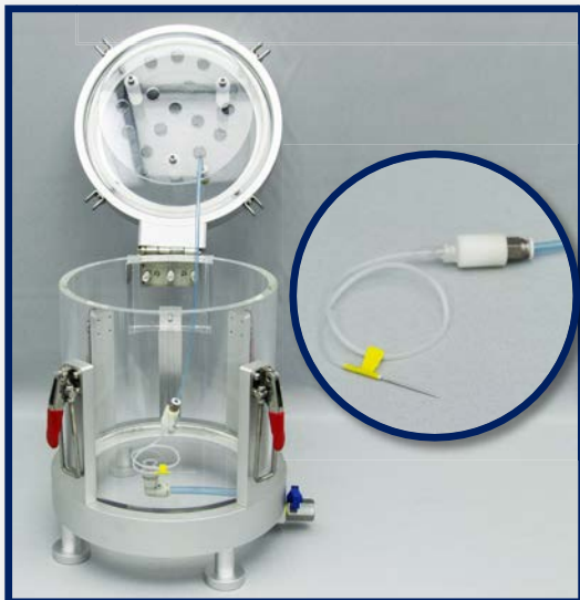
Камера для випробування на вакуум і тиск зі спеціальною голкою
