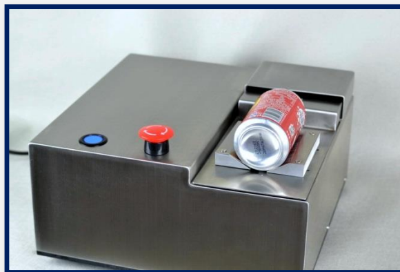
Пилки для підготовки зрізу ANSS та SS-1
