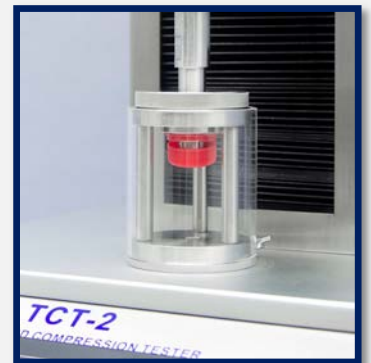
Випробування пояса кришки на TCT-2
