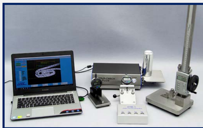
SeamCheck Plus можна поєднувати з іншими пристроями для контролю банки через DTB-1
