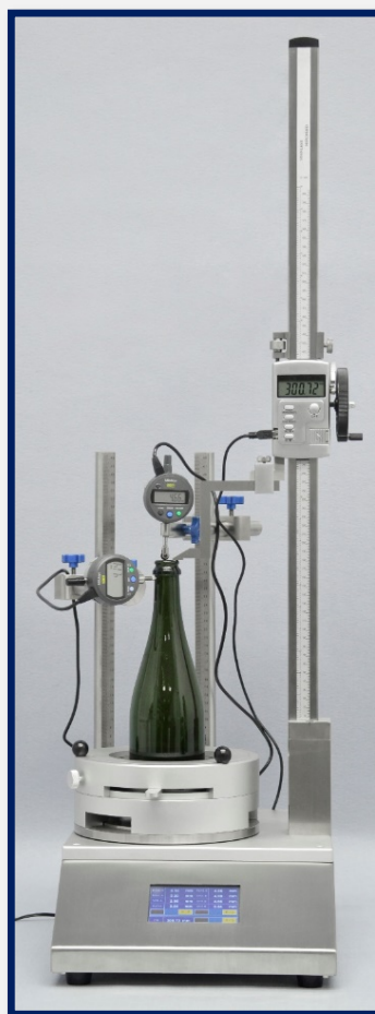
UBPT-3 з 2 індикаторами, висотоміром та автоматичним калькулятором
