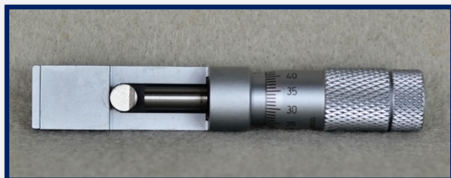
Мікрометр CSM-B для алюмінієвих банок
