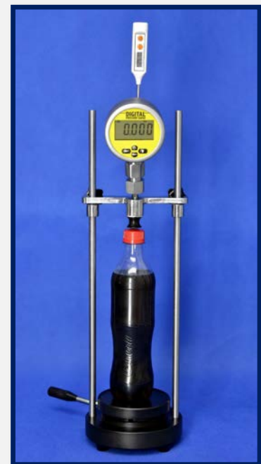
CO 2 EASY-D з цифровим манометром
